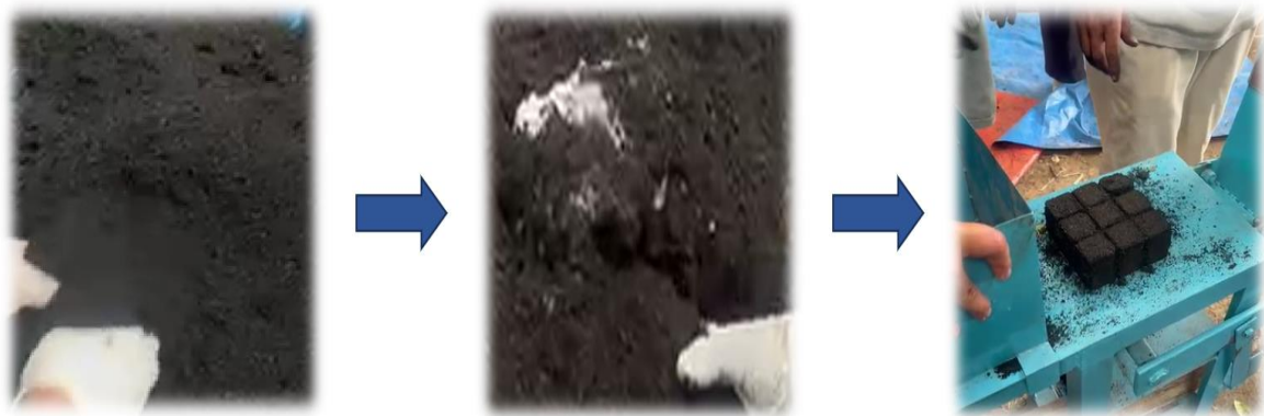
Gambar 6. Proses pencampuran dan pencetakan briket
