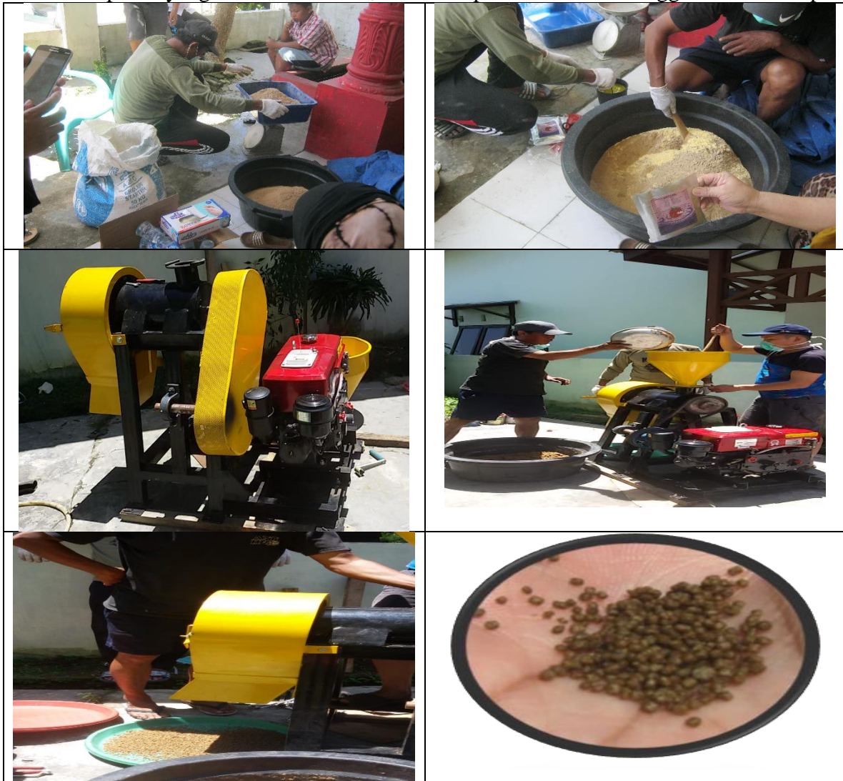
Gambar 3. Proses pembuatan pakan pellet
