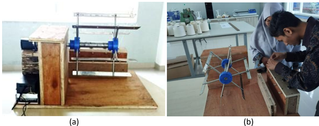
Gambar 3. Tampilan alat pengukur densitas benang berbasis Arduino yang telah selesai dirakit, baik dari sisi (a) depan maupun (b) samping
